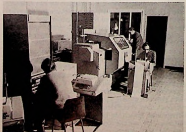
PDP-8/e bestuurt een draaibank te Hasselt
